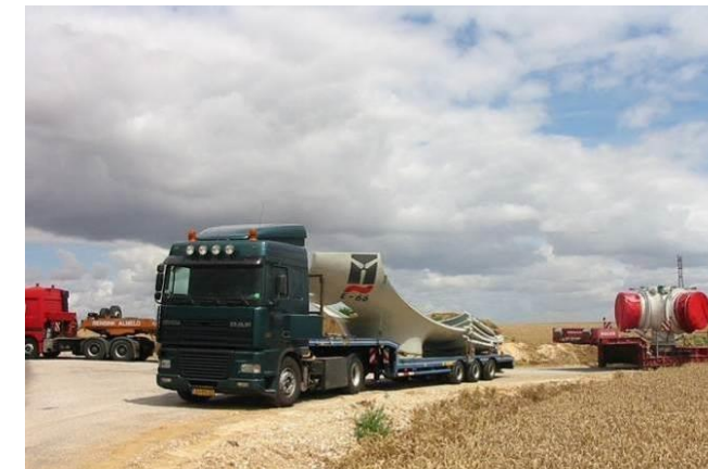
Transport des composants d'une éolienne
